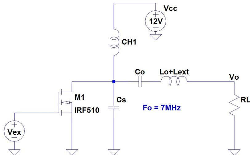
1. Si la potencia requerida en  $R_L$  es de 10 Watts, usando las ecuaciones de diseño calcule el valor de los componentes. Considere  $Q_{L_o} = 10$ .
