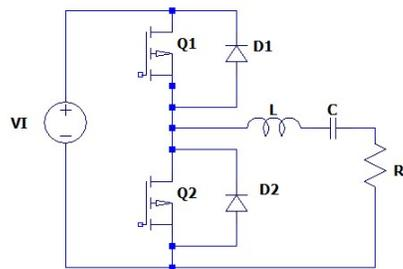
Diseñar un amplificador de potencia clase D con MOSFET con el circuito que se muestra y las siguientes características:
